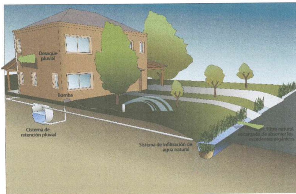
Figura 28: En esta imagen se puede ver como el agua de lluvia que cae en los techos, es recolectada y reservada en un taque cisterna, que luego podrá ser utilizada para el riego del jardín del propietario.
